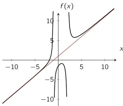
Abbildung 10: Rationale Funktionen  $f(x) = \frac{x^3-2x+2}{x^2-x-2} = x + 1 + \frac{x+5}{x^2-x-2}$
